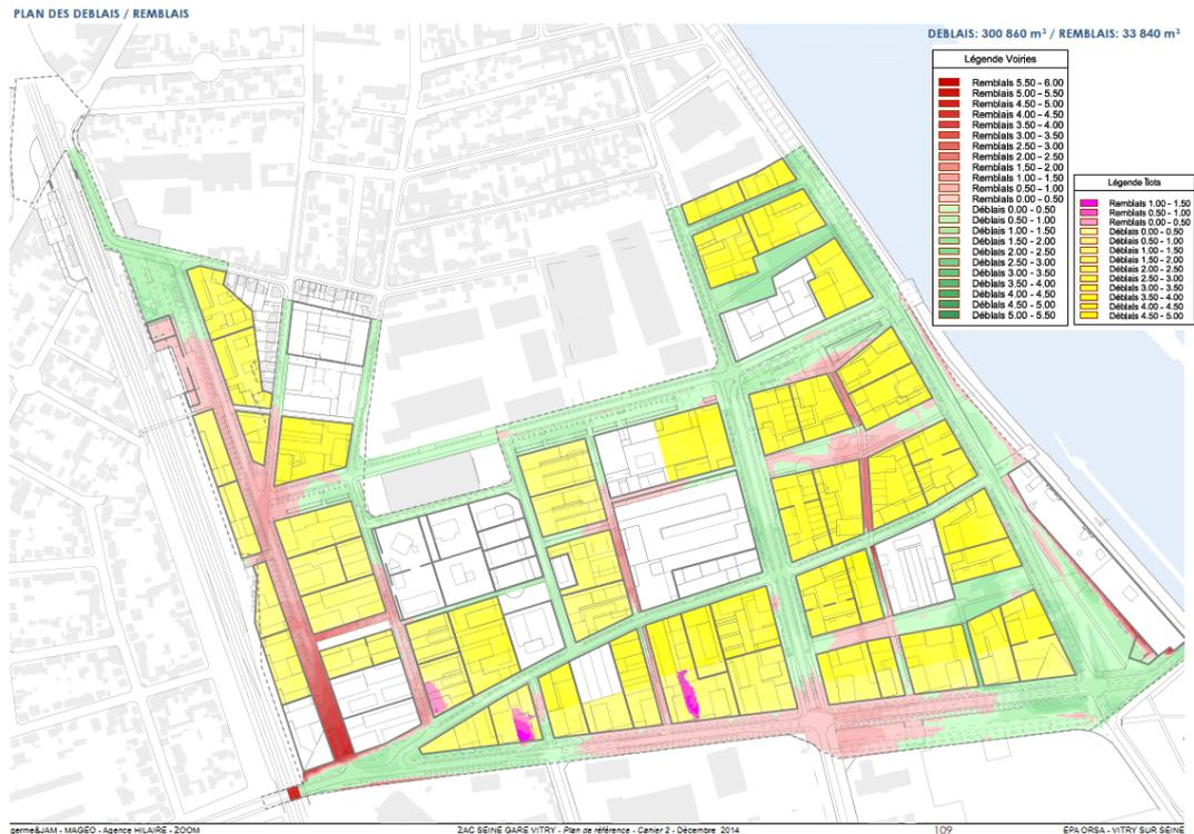
Fig. 15. Plans des reblais déblais sur la ZAC. Source Germe et Jam décembre 2014
